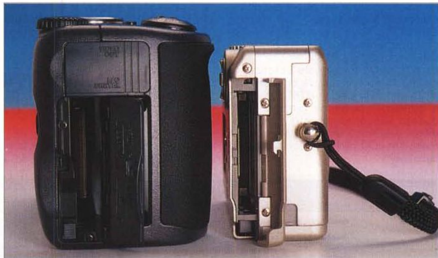
Solo la Canon, tra le due fotocamere, offre la possibilità di montare CompactFlash di tipo II. Lo si può vedere anche dalla fessura di dimensioni leggermente superiori, in grado di ospitare lo spessore di un Microdrive IBM, il piccolo hard disk da 170 o 340 MB.
